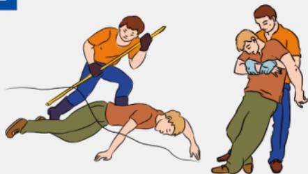
Сбрось с пострадавшего провод сухим, не проводящим ток, предметом (палка, пластик). Оттащи пострадавшего за одежду не менее чем на 10 метров от места касания проводом земли или от оборудования, находящегося под напряжением.\*
